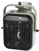
Aeroterms murales de instalación fija, para calentar locales comerciales o industriales. Protección contra salpicaduras de agua, índice de protección IP24. Con ventilador axial muy silencioso, fabricados en chapa de acero pintada. Disponen de un interruptor posterior que permite seleccionar que el termostato actúe sobre el ventilador resistencia, o sólo sobre la resistencia y de un botón de rearme manual (RESET).
